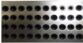
Рисунок 32. Генераторы турбулентности Hergel – примерная копия генераторов турбулентности Voith (характерная квадратная форма выхода массы)
