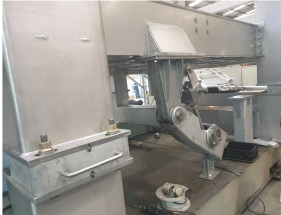
Рисунок 40. Фрагмент стандовой сборки сеточного стола на заводе Hergen
