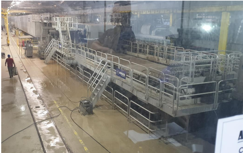
Рисунок 39. Сеточный стол БДМ на заводе Guarí, вид сверху
