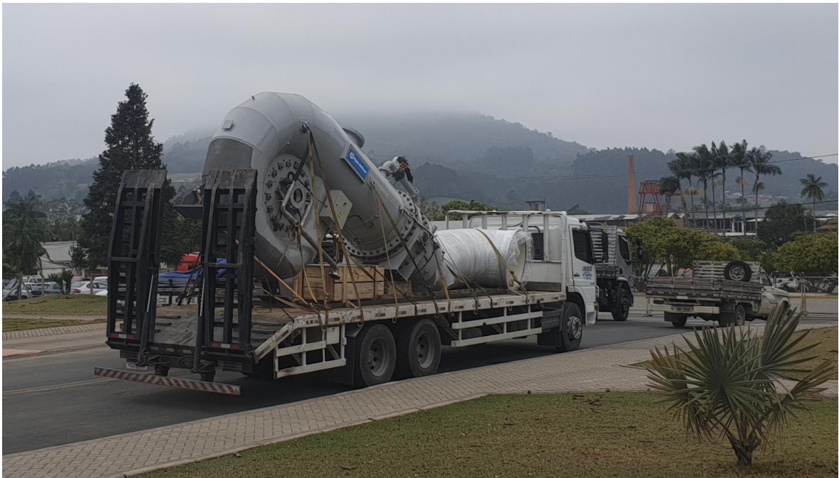
Рисунок 13. Отгрузка турбинного агрегата Френсиса, см. link
