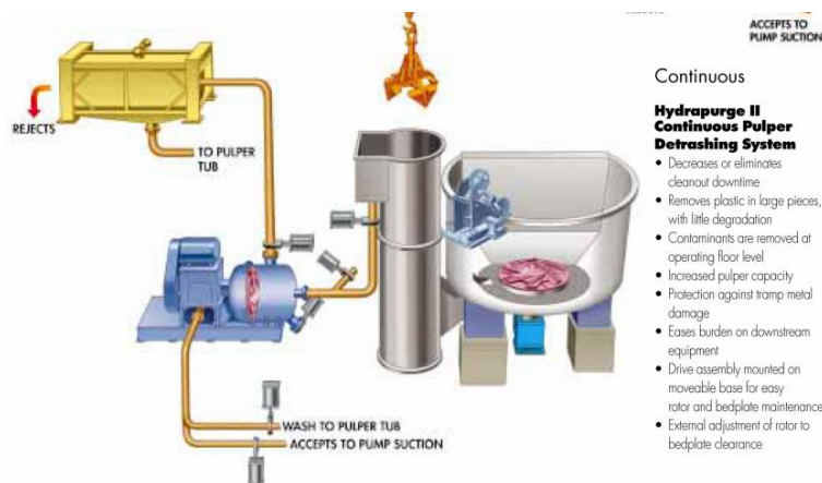
Рисунок 61. Пример классической схемы роспуска kadant 2-го поколения с Hydrarurger.
