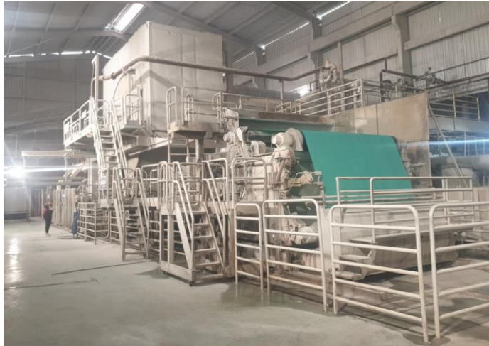
Рисунок 20. Второй шаг модернизации - вытяжной колпак
