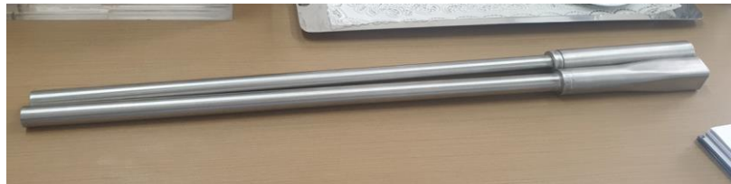
Рисунок 32. Генераторы турбулентности Hergel – примерная копия генераторов турбулентности Voith (характерная квадратная форма выхода массы)
