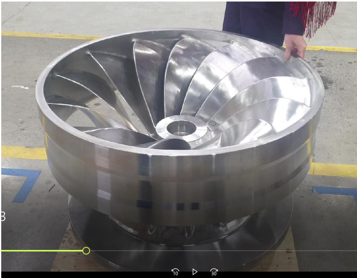
Рисунок 14. Колесо турбины Френсиса, см. link
