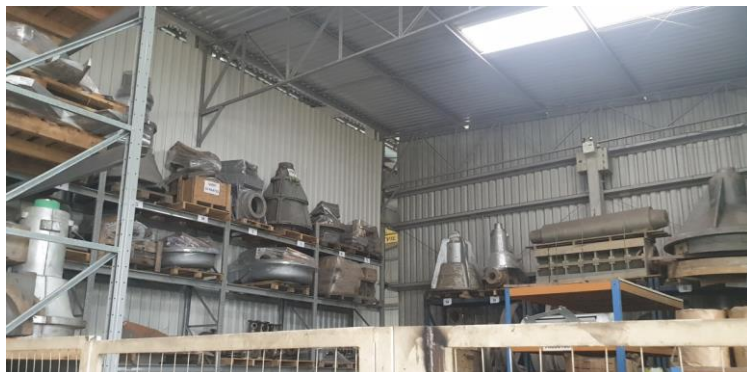
Рисунок 57. Литьевые формы для изготовления (отливки) хаба и подшипникового узла ГРВ. Компания Neofiber охотно выполняет модернизации в Бразилии. В РФ без сильного местного представителя это будет затруднено
