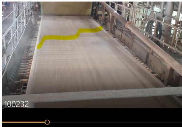
Рисунок 37. Новый (менее 5 лет) напорный ящик Nergen в работе, 2540мм, 740 м/мин, Trombini. Есть потенциал для улучшений, вероятно, плохо настроена рециркуляция
