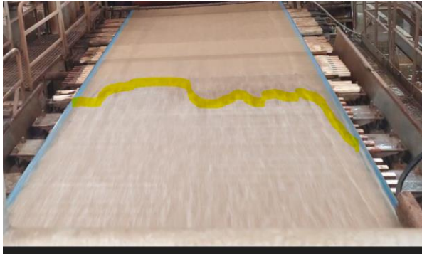
Рисунок 36. Старый напорный ящик Nergen в работе (10 лет), Trombini, 2540мм, примерно 500-600 м/мин. Наблюдается излишняя макротурбулентность, что может говорить о неправильном режиме работы
